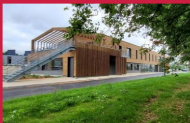
Le brise-soleil, un outil low-tech qui permet de se protéger de la chaleur plutôt que de climatiser. Crédits @VICTOIRE JONCHERAY
